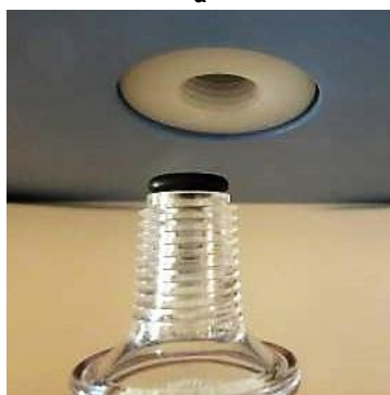
Рисунок 19. Установка 0,22 мкм фильтра диспенсера.
