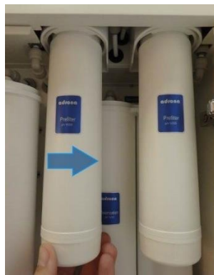
Рисунок 15. Установка фильтров предварительной очистки.
