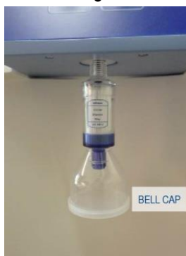
Рисунок 19. Установка 0,22 мкм фильтра диспенсера.
